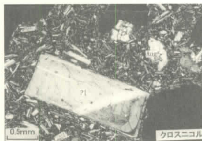
写真-2 試料 K-1の偏光顕微鏡写真(左側：単ニコル，右側：クロスニコル)。Pl=斜長石，Aug=普通輝石
