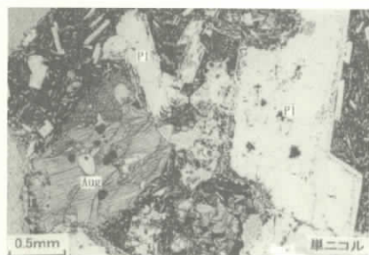
写真—4 試料 K-3の偏光顕微鏡写真(左側：単ニコル，右側：クロスニコル)，Pl=斜長石，Aug=普通輝石
