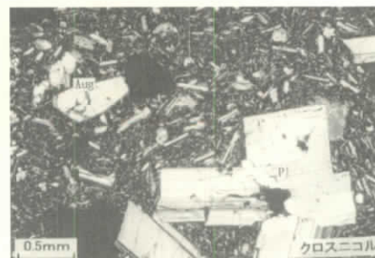
写真-3 試料 K-1の偏光顕微鏡写真(左側：単ニコル，右側：クロスニコル)。Pl=斜長石，Aug=普通輝石
