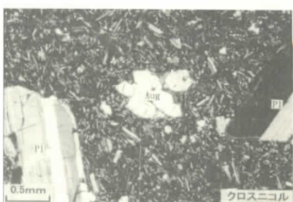
写真—6 試料 K-3の偏光顕微鏡写真(左側：単ニコル，右側：クロスニコル)，Pl=斜長石，Aug=普通輝石
