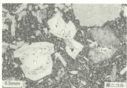
写真—5 試料 K-3の偏光顕微鏡写真(左側：単ニコル，右側：クロスニコル)，Pl=斜長石，Aug=普通輝石
