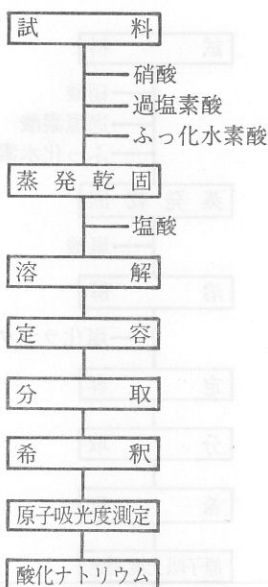
FIG. 6 酸化ナトリウム (Na 2 O) 定量方法の流れ図 The Flow Chart of Chemical Composition Analysis of Na 2 O
