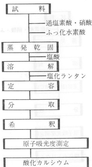
FIG. 7 酸化カルシウム (CaO) の定量方法
