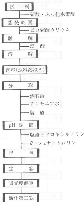
FIG. 4 酸化第二鉄 (Fe 2 O 3 ) の定量方法 The Flow Chart of Chemical Composition Analysis for Fe 2 O 3
